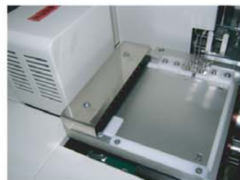
试剂槽冷却器
